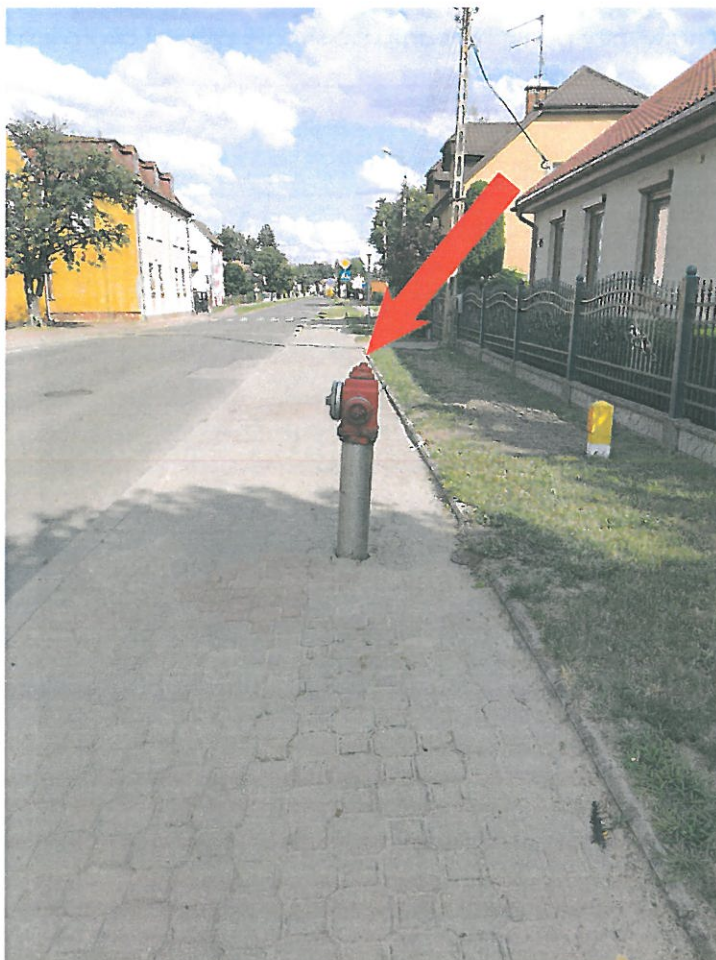
Reper roboczy nr 4 - najwyższy punkt hydrantu po stronie prawej około km 0+588 H=103.28
