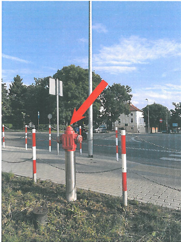
Reper roboczy nr 13 - najwyższy punkt hydrantu po stronie lewej około km 1+485 H=117.28
