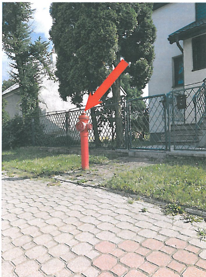
Reper roboczy nr 2 - najwyższy punkt hydrantu po stronie prawej około km 0+428 H=104.08
