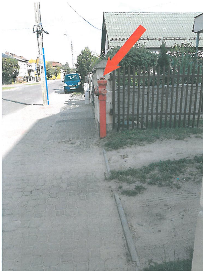
Reper roboczy nr 3 - najwyższy punkt hydrantu po stronie prawej około km 0+510 H=104.06
