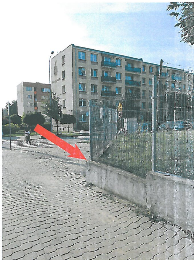
Reper roboczy nr 11 - na cokole ogrodzenia po stronie lewej około km 1+336 H=109.67
