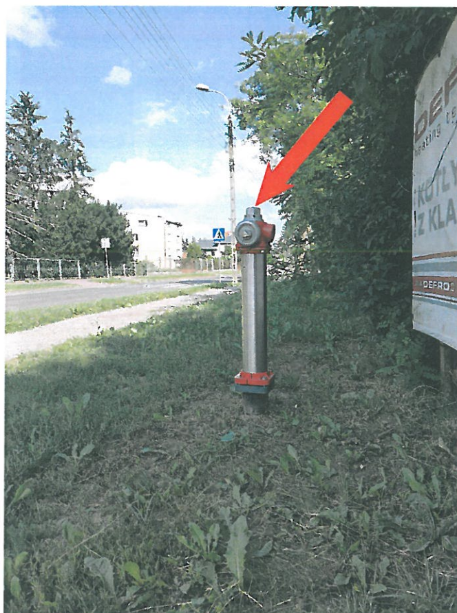
Reper roboczy nr 6 - najwyższy punkt hydrantu po stronie prawej około km 0+770 H=103.80
