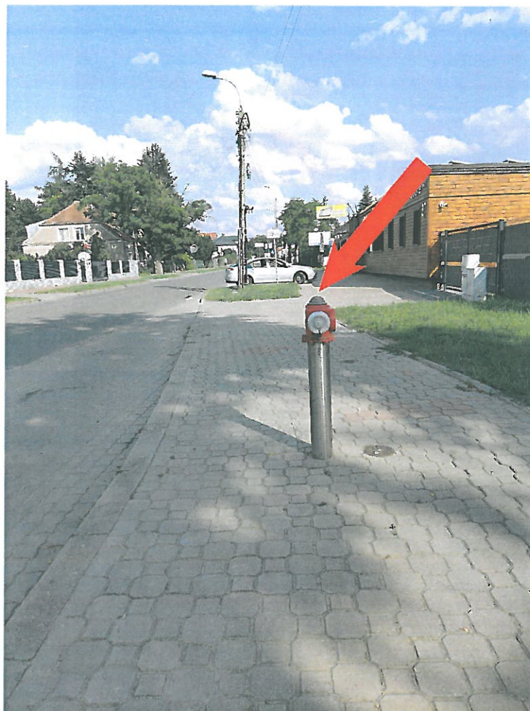
Reper roboczy nr 5 - najwyższy punkt hydrantu po stronie prawej około km 0+704 H=103.26
